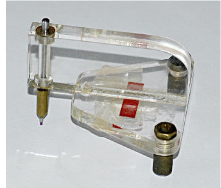
Figura 1 - Carrinho com estilete duplo próprio para gravar vias de comunicação a dois traços, ou simples para as curvas de nível
